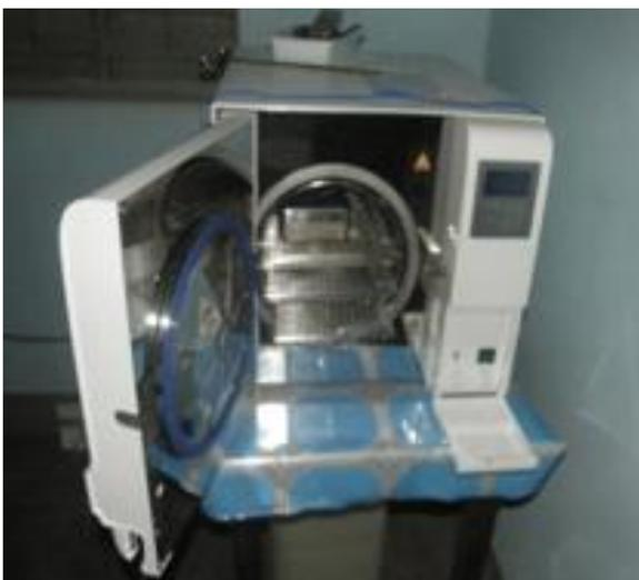
Autoclave utilisé pour la stérilisation du matériel, en particulier pour les DERMOJETS.
